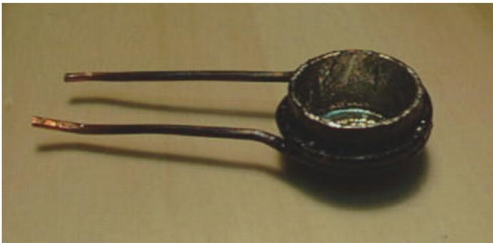
**Crisol de construcción casera para la limpieza y estañado de los terminales de las bobinas**
